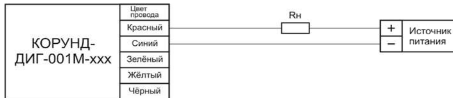
Рис.Б1. Схема соединения датчиков КОРУНД-ДИГ-001М(МН) с выходным сигналом 4-20 мА, 20-4 мА, HART (двухпроводная).
